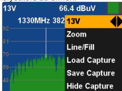
3. Speichern und laden Sie die erfassten Daten für den Vergleich der Spur des Spektrums.
