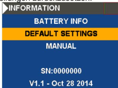
Um vor dem versehentlichen Rücksetzen des Gerätes zu schützen, erhalten Sie hier ein Sicherheitsabfrage, ob das Gerät wirklich auf die Werkseinstellungen gesetzt werden soll.
