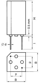
$\begin{array}{lll} B & 7.4 \pm ^{+0}_{-1} \, \text{mm} \\ H & \leq 13.1 \, \text{mm} \\ p & 5.08 \, \text{mm} \\ I & \text{Standard } 3.1 \pm 0.3 \, \text{mm} \\ & \text{Optional } 6\text{--}10 \, \text{mm} \, \text{with} \\ & \text{tolerance} ^{+0}_{-1} \\ d & 0.6 \, \text{mm} \\ & \text{Weight } 1.2 \, \text{g} \end{array}$
