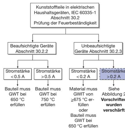
Abbildung 1: Übersicht der Kunststoffteile in elektrischen Haushaltsgeräten
