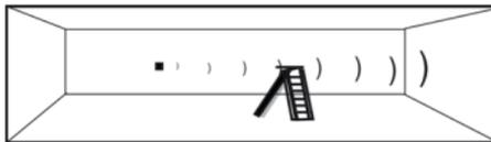
In der Grafik wird nicht wie gewünscht der Abstand zur Mauer, sondern nur die Distanz zur Leiter ermittelt. Das Messgerät benötigt zur exakten Messung einen freien Messkegel von +/- 7°.
