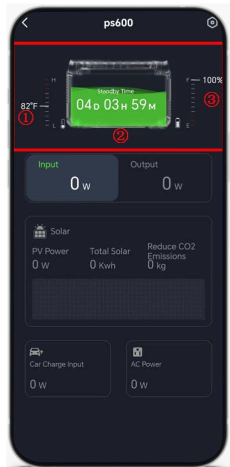
11. Wejście Wskazuje całkowitą moc wejściową. Jak pokazano na rysunku, ①~③ to wskaźnik mocy w stanie korzystania z paneli słonecznych, odnoszący się odpowiednio do mocy fotowoltaicznej, całkowitego wytwarzania energii słonecznej i redukcji emisji dwutlenku węgla. ④ to moc ładowania produktu poprzez podłączenie zapalniczki samochodowej za pośrednictwem akcesorium, ⑤ to moc wejściowa prądu zmiennego.
