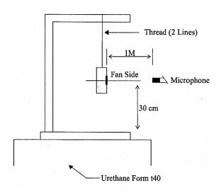
1 METER FROM MICROPHONE TO FAN INTAKE
