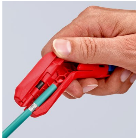
Afisolering af et datakabel
