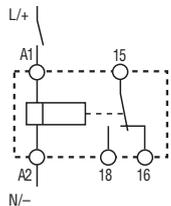
Ansteuerung über Startkontakt in der Steuerleitung zu B1
