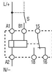
Ansteuerung über Startkontakt in der Steuerleitung zu B1
