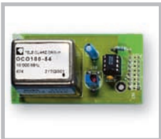
Option H085, ein hochstabiler Oszillator mit einer Stabilität von \pm 5 \times 10^{-9} pro Tag
