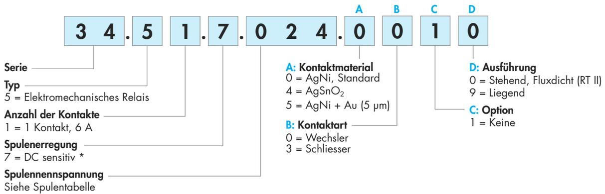
\* Die DC-Relais sind über Fassungen mit entsprechender Beschaltung an AC, AC/DC oder Spannungen > 60 V zu betreiben, siehe Fassungen Serie 93.
