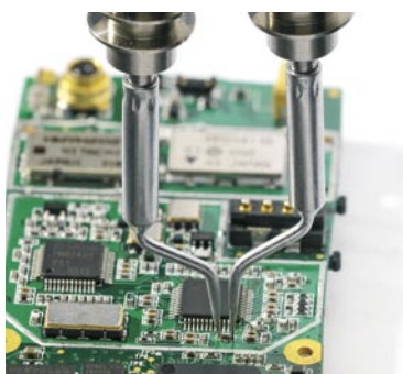
Spezielle Chip Tool-Spitzen zum 0201 Rework.
