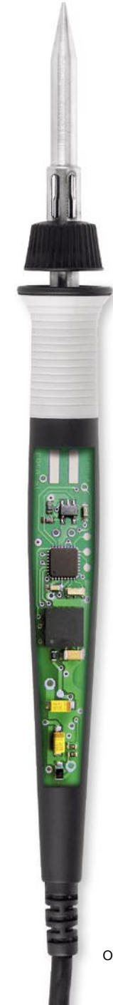
Die fortschrittliche, im Griff integrierte Elektronik macht den ERSa i-Tool zum intelligentesten LötKolben der Welt.
