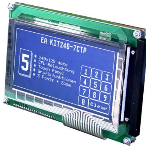
EA KIT240-7CTP Abmessungen 144x104mm
