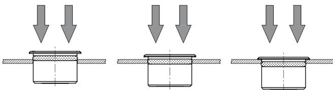
Die Montage erfolgt durch das Einpressen des Tasters in die Bohrung, wobei der O-Ring des Tasters verdrängt wird und nach dem Austritt aus der Bohrung sich wieder erweitert. Dadurch wird der Taster in der Bohrung festgehalten.
